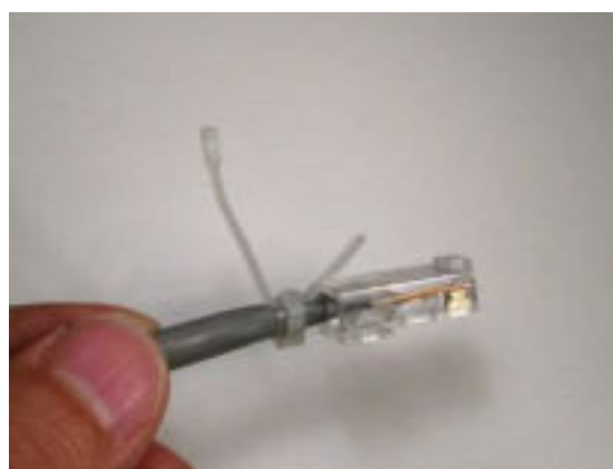
Obr. 36 – UTP konektor a tzv. packa Zdroj: Vlastní Obr. 37 – Opravený UTP kabel Zdroj: vlastní
